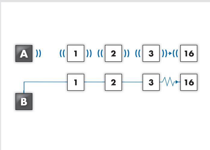
Cada IntelliBox puede controlar hasta 16 cañones de niebla. Se puede configurar de forma sencilla una instalación inalámbrica (A) o cableada (B) o una combinación de ambas.
