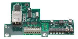
Questa scheda di espansione sviluppata da PROTECT™, disponibile per tutta la gamma di nebbiogeni, permette di gestire ogni dispositivo per la sicurezza attiva tramite una connessione remota IP. Grazie alla scheda il vostro nebbiogeno potrà interfacciarsi col software IntelliSuite per scaricare e analizzare i dati, riducendo in questo modo i costi di assistenza e intervento.
