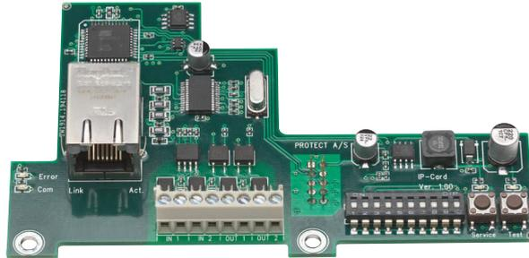
PROTECT IPCard ist eine Speichererweiterungskarte, die für die ganze Produktpalette von PROTECT-Nebelsystemen zur Verfügung steht. Dank dieser Karte ist es möglich, ein Nebelgeneratorsystem mit Hilfe der Fernverbindung IP (Internet) zu verwalten sowie seine Möglichkeiten wesentlich zu erweitern:
